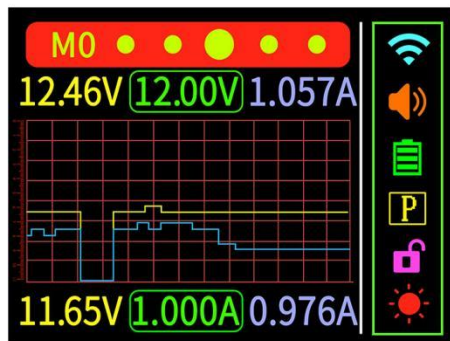
电压/电流曲线界面
